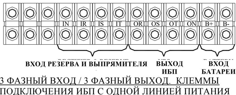
☆☆☆ Три дополнительные клеммы установлены для удобства перемонтажа на отдельный резервный вход.
